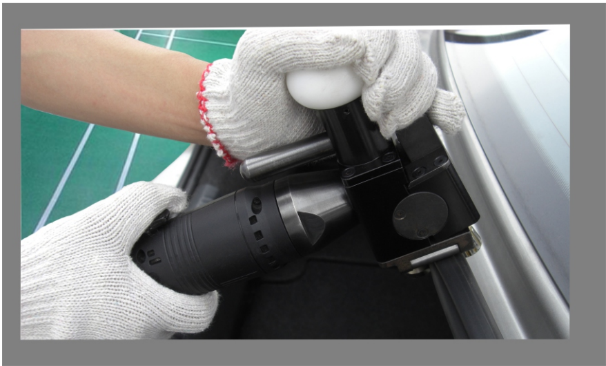
型号: ATV-100SR 汽车密封条滚压装置
