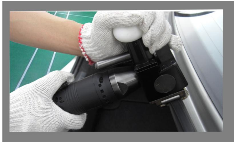
型号: ATV-100SR 汽车密封条滚压装置
